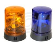
М302 служит для оптической предупредительной сигнализации на спецтранспорте. Электромеханический механизм состоит из стационарной галогеновой лампы и оборотной светосигнальной системы, образующей проблески. Роликовый подшипник предотвращает шум от работы прибора.
