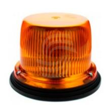
Импульсный 3-светодиодный сигнализатор ФП-1(1M)-120Д3 с пониженным энергопотреблением. Компактные габариты способствуют легкому соединению с крышей авто за счет фланцевых или магнитных держателей. Поликарбонатный 3-цветный светорассеивающий плафон имеет гофрированную поверхность, что расширяет угол действия светоизлучающих диодов. Вертикальная обзорность прибора составляет 10°, горизонтальная - 360°.
