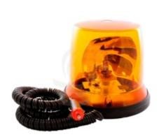
СПЕКТР - модель с обширной отражательной площадью, позволяющей выдавать мощный и стабильный проблеск. Механико-магнитное соединение поликарбонатного плафона с крышей автомобиля через поднятую на ножках металлическую платформу обеспечивает легкую установку и предохранение от влаги. Работоспособность - 4 тыс. ч. без перерыва при температуре от -50 до +50 °C. На выбор 4 варианта цветового оформления плафонов.
